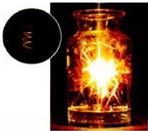
图2-13 铁丝在空气中红热，在氧气中燃烧，生成四氧化三铁
