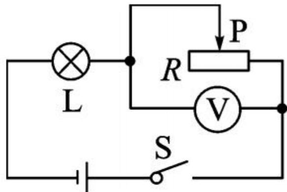
当滑动变阻器的滑片 P 移动到中点时, 灯 L 正常发光, 电压表示数为 4V; 当滑片 P 移到最大阻值时, 灯 L 与滑动变阻器的电功率之比为 ( )
